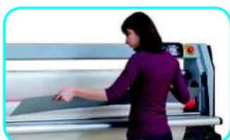
La máquina se entrega con una bandeja de metal con el fin de reducir el desperdicio de material y ahorrar tiempo cuando se carga el film en la laminadora
