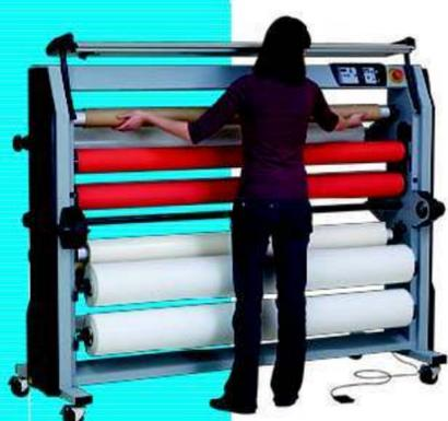
Con los nuevos ejes ligeros con sistema auto-blocante, ahorrará tiempo cambiando el film. No se requieren herramientas a diferencia de sistemas que utilizan anillos de bloqueo o ejes pivotantes que usan gran espacio detrás de la máquina. Los ejes porta-rollos pueden ser usados en cualquier posición de la máquina y en ambos sentidos de giro.
