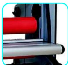
La apertura de rodillos hasta 50 mm, ofrece un amplio rango de usos, incluso si usted no dispone de un sistema de impresión plano en su taller.
