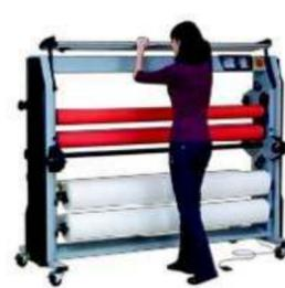
La bandeja de entrada de material es pivotante y se levanta totalmente dejando un completo y seguro acceso a la máquina mientras se carga el film. En esta posición superior, la marcha del motor está desconectada, previniendo al operario de cualquier daño durante la operación de carga.
