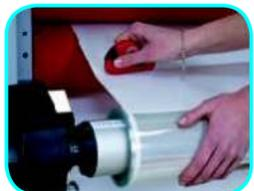
Con el fin de proteger los rodillos de laminado cuando no se utiliza una cuchilla apropiada, un cutter de seguridad es entregado con la máquina. La calidad de sus trabajos de laminación y su inversión estarán preservados durante años.
