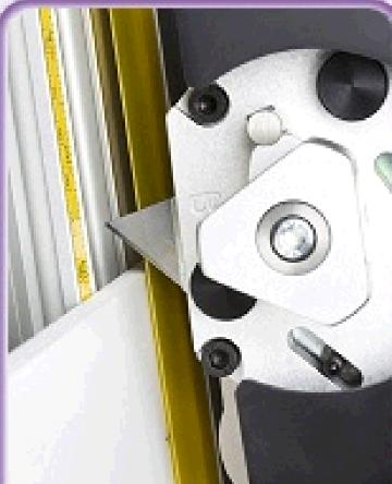
Exclusivo - Cabezal de corte universal de 4 herramientas con separación automática de la cuchilla al final del corte
